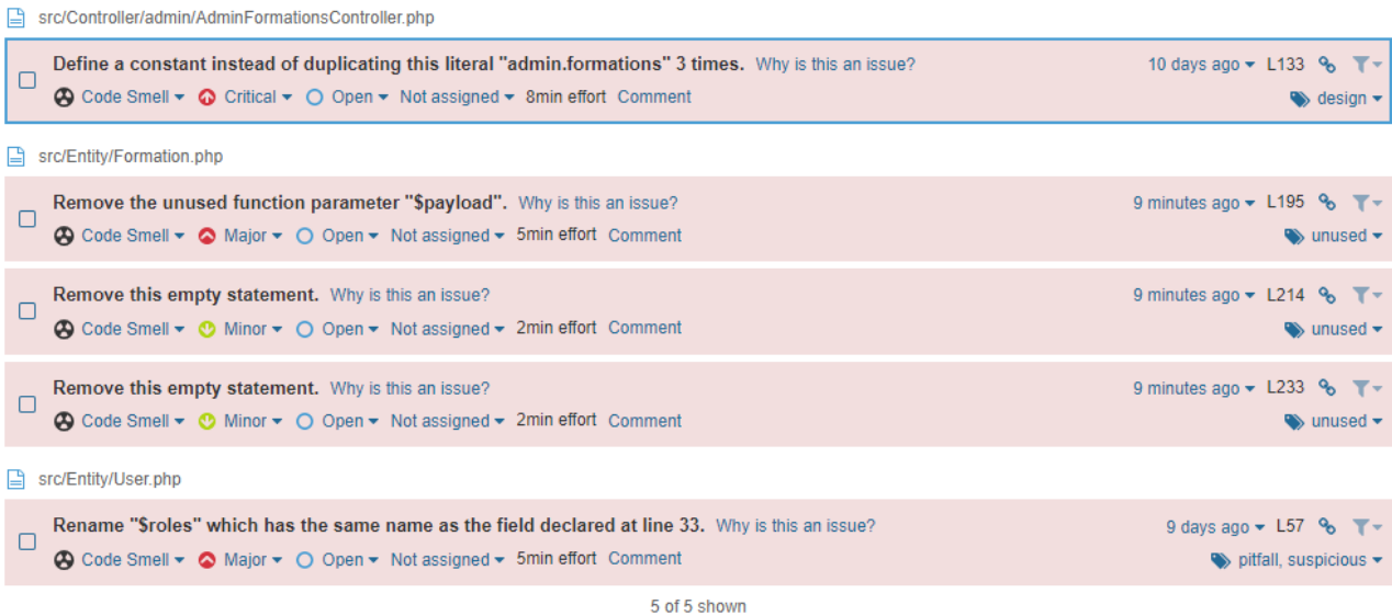
Figure 93: Les 'code smells' trouvés par SonarQube
